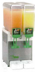
⑥ コールドドリンクディスペンサー JOLLY8.2G (2連タイプ) 5750100 外寸：246×399×H625 重量：17kg 容量：8ℓ×2 電源：単相100V 300W 冷却温度：3～7℃ 攪拌方式：横噴流式
