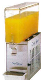
③ ドリンクディスペンサー DS-10S コールド 3138300 単相100V 240W 容量：10ℓ 外寸：172×440×H572 温度調節：3℃～7℃ 重量：16.5kg 容器材質：ポリカーボネイト
