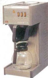
⑧ コーヒーマシン FKM-N72B メリタ 1538000 外寸：230×355×H495 重量：7.0kg 電源：AC100V 1,000W 排出量：13杯 (1.8ℓ) / 回 78杯 (9.8ℓ) / 時 ●デカンター P601を使用 ●バスケットP602 27cmを使用
