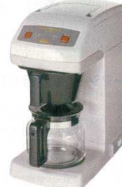
⑨ コーヒーマシン ET-250 カリタ 4014200 外寸：200×375×H420 重量：5.1kg 電源：100V/920W 50/60Hz 最大使用水量：1.7ℓ 能力：約60杯/h 使用ロシ：立ロシ25cm 付属品：ファンネル#250、1.7ℓ デカンタ 2,000cc計量カップ ●しずくだれ防止装置付
