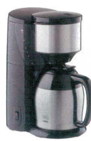
④ アロマサーモ 10カップ 1031 メリタ 1532000 外寸：252×199×H351 容量：1.4ℓ (3～10杯) 重量：2.45kg 電源：単相100V 850W ●サーモ社のステンレス製真空二層構造ポット を採用。真空二層式のため保温性が高く、いれ たての温度を保ちます。 ●安定した高温抽出でアロマを引き出すバイメタル方式。 ●オートオフ機能付。
