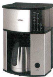
⑤ 真空断熱ポット コーヒーメーカー サーモス ECD-1000 1674910 寸法：240×240(ポットハンドル部含む)×H360 重量：約3.3kg(ポット含む) 電源：100V/700W 容量：1.0ℓ(ポット) ●マイコンで蒸らし時間を 制御、おいしくドリップ ●ドリップ完了後は自動的 に電源がオフになるオート オフ機能 ●ドリップ完了をお知らせ するブザー ●中せんをつけたままド リップできるドリップス ルー機構 ●ポットを外すとすぐに 止まるドリップストップ パー機構 ●お手入れしやすい着脱式 の給水タンク ●見やすい水量計付き ●本体・ポットは汚れにく いステンレスクリアコー ト加工 ●繰り返し使えるメッシュ フィルター付き (ペーパーフィルターも使 えます)
