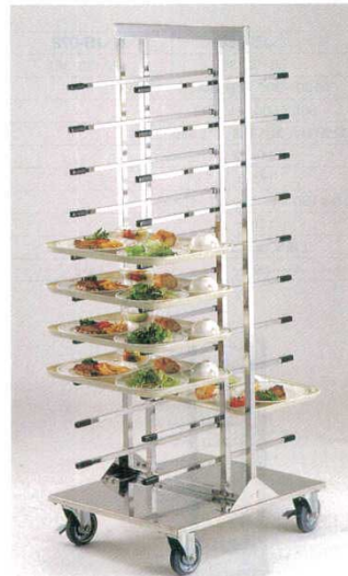
④ディッシュスタック トレイ用 EBM 600×600×H1,760 4111300 バーの長さ: 320mm バーは最大482mm (W) から50mmきざみで最小182mm (W) まで移動します。 両面で20枚のトレイがのります。 ※キャスターφ150 4輪自在 (内2 ケストッパー付)
