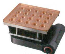
⑪ たこ焼・あかし焼用 銅板 20穴 卓上型 EGT1-20 0231100 外寸: 320×270×H95 穴のサイズ: φ45×H22.5 銅板厚: 1.5mm 質量: 3.0kg ※イワタニカセットフー「強火じまん」CB-AL 35 専用です。 ※写真のカセットコンロは別売です。(P.750を ご参照ください)
