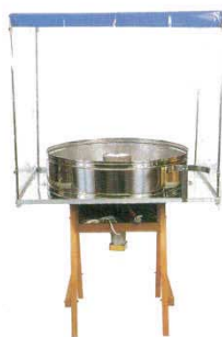
⑤ わた菓子機 TG-8型 ガス式 LP 直 6455600 外寸：910×700×H1,580 能力：1分毎に5~8本 重量：20.7kg ガス消費量：0.1kg/h 燃焼部 電源：100V 20W 回転部 ガス接続口：LPガスφ10 ※LPガス用のみとなります
