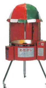
⑧ わた菓子自動販売機 CA-6型 電気式 直 6455500 外寸：730×510×H1,380 能力：1分毎に1本 重量：20kg 電源：100V 700W ※100円を入れると釜が回る。(1分20秒位)釜 が回りはじめて5秒位すると12gのザラメの 砂糖が落ちる。それを箸で取る。
