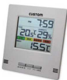
⑬ カスタム デジタル熱中症計 HI-300 FJ 122×17×H136 0265900 ¥5,980 重量:約168g(電池含む) 測定範囲:温度-10~50°C、湿度20~90%RH 時計表示は12時間、24時間表示の切り替えが可能。 アラーム設定可能範囲:温度/-50~70°C、湿度/0~99%RH、 熱中症(WBGT)指数/-50~70°C 分解能:(温度)0.1°C、(湿度)1%RH 測定精度:温度/±1°C(0~40°C) ±2°C(上記以外) 電源:単4(1.5V)電池2本 ●大型3段表示(時計表示、温湿度表示、WBGT指数+危険レベルアイコン) ●温度、湿度、WBGT指数のMAX(最大値)/MIN(最小値)表示機能付 ●スタンド、壁掛け用フック穴付 ●それぞれのWBGT値により危険レベルのアイコンが点灯します。 (25°C未満=注意、25~28°C=警戒、28~31°C=厳重警戒、31°C以上=危険) ●予め設定した値(温度、湿度、WBGT指数のそれぞれ)を超えるとアラームが鳴ります。
