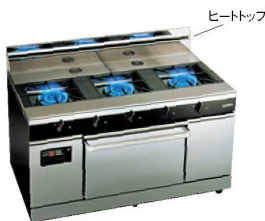
⑦ガスレンジ OZL-1500EC A 電源:単相100V 50/60Hz 消費電力:120W ●コンピュータによるオープン温度調節範囲 60℃～400℃ ●間接加熱のヒートトップ付 ※立消え安全装置付
