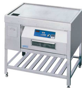
⑨電磁グリドル MIG-900N 0730300 ¥1,680,000 外形寸法:900×600×H800 グリドル板:850×550 電気容量:3相200V 5.6KVA 加熱出力:5.0kW リード線2m・プラグ付:接地3P-20A 一次側定格電流値(A):16 ブレーカー容量(A):3極:30 重量:93kg ●パワーは微弱から強まで自在にコントロール
