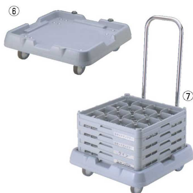
BK ラックドリー 商品コード 価格 ⑥ ハンドル無 PR-1 595×595×H182 4973200 ¥31,500 ⑦ ハンドル付 PR-2 595×595×H940 4973300 ¥36,700 材質:本体/ポリプロピレン樹脂 バイブ/SUS430ステンレス キャスター/ゴム製φ100 (自在×2 固定×2) 積載重量:160kg
