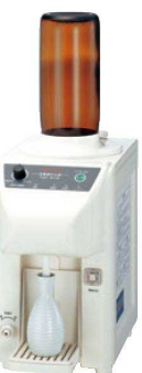
⑦瞬間加熱式 酒燗器 TSK-N11R ㉔ 7384500 ¥100,000 電源:単相100V 50/60Hz 消費電力:1.3kW 重量:4.5kg ●お酒が特殊ガラス管ヒーターの中を通る間に加熱されるため、旨味が損なわれません。 ●ぬる燗(45℃)～あつ燗(65℃)まで、マイコン制御の温度管理により、いつでもお好みの温度で採酒できます。 ●お燗をせずに、常温酒を採酒したい時はヒータースイッチを切るだけで採酒できます。 ●「採酒終了」「酒補給」をアラームで知らせる親切設計 ※紙バックでのご使用もできます。その際は専用スタンドを別途取付加工が必要となります。
