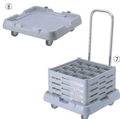
BK ラックドーリー 商品コード 価格 ⑥ ハンドル無 PR-1 595×595×H182 4973200 ¥31,500 ⑦ ハンドル付 PR-2 595×595×H940 4973300 ¥36,700 材質:本体/ポリプロピレン樹脂 バイブ/SUS430ステンレス キャスター:ゴム製φ100(自在×2 固定×2) 積載重量:160kg
