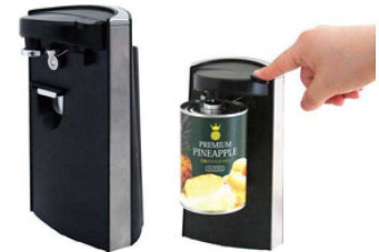
⑥電動缶切り 正宗 CO2061 ¥5,500 0028500 ¥5,500 サイズ:131×130×H213 重量:900g 電源:単相100V 50/60Hz 定格時間:2分(30分休止) 消費電力:70/50W 材質:本体/ABS樹脂、刃/ステンレス 対応サイズ:直径54mm~155mm、高さ33mm以上、丸型、 フチの高さが2~4mm(3号缶サイズまで) ●缶をセットしてレバーを押すだけの簡単操作です。 ●レバーを押した後は、自動で缶が回転し、缶切り刃で缶を開封 していきます。
