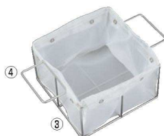
③EBM オイルフィルター 一斗缶用 【注】 0390610 ¥8,000 外寸:200×200×H120 アミ目:120メッシュ 耐熱温度:200℃
