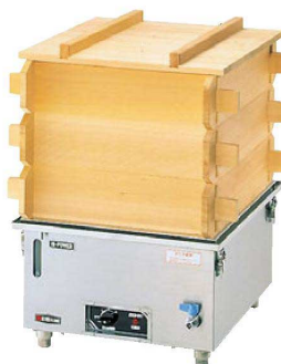
⑦電気蒸器 M-22 3079600 ¥210,000 外寸:500×550×H300 電源:3相200V 消費電力:4.5kW 温度調節:3段切替方式(保温機能付) 重量:20kg 湯槽:22ℓ 蒸気立上りまでの時間:30分 蒸し台ノズル数:φ15×5穴 ※角セイロ42cm、中華セイロ42cm3段まで ご使用できます。
