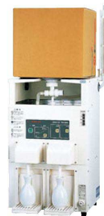
⑤酒燗器 TSK-230B 3125520 ¥205,000 キュービテナー専用型(酒量計付) 電源:100V 消費電力:1kW 酒容量:キュービテナー5ℓ〜18ℓ対応可能
