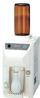
⑦瞬間加熱式 酒燗器 TSK-N11R 7384500 ¥100,000 電源:単相100V 50/60Hz 消費電力:1.3kW 重量:4.5kg ●お酒が特殊ガラス管ヒーターの中を通る間に加熱されるため、旨味が損なわれません。 ●ぬる燗(45℃)〜あつ燗(65℃)まで、マイコン制御の温度管理により、いつでもお好みの温度で採酒できます。 ●お燗をせずに、常温酒を採酒したい時はヒータースイッチを切るだけで採酒できます。 ●「採酒終了」「酒桶給」をアラームで知らせる親切設計 ※紙バックでのご使用もできます。その際は専用スタンドを別途取付加工が必要となります。
