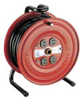
①コードリール S-30 71 5336410 ¥9,000 定格:15A 125V コード電線:1.25mm 2 30m コンセントボックス:4個
