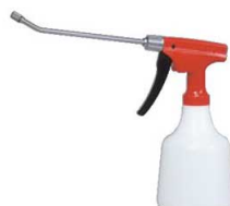
⑯ロングピストル型噴霧器 #530 レッド φ95×H240 1093800 ¥2,000 容量:500cc ノズルの長さ:180 材質:本体/PP 容器/ポリエチレン ●1回のハンドル作動で1m2噴霧
