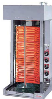
⑥シェラスコ焼器 KMT-10 ㊦ 6940510 ¥838,000 外寸:505×480×H1,070 電源:3相 200V ※リード線2m付直結タイプ 消費電力:10.2kW 重量:47kg 付属品:焼串用キャップ ●肉を吊るし回転させながら焼くので、火が内部までムラなく通ります。 ●上、中、下ヒーターにより各ヒーターの温度調整が可能です。
