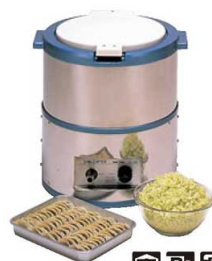
③プロシェフ 野菜脱水機 卓上型 VS-250N 0804700 ¥220,000 外寸:430×388×H457 電源:単相100V 50/60Hz 定格消費電力:175/135W 定格時間:連続 重量:26kg ●タイマースイッチ付(最長15分) ●4kgタイプ ●キャベツなら約2分で3kgを脱水することができま ※絞り袋付
