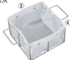
③EBM オイルフィルター 一斗缶用 ㊦ 0390610 ¥8,000 外寸:200×200×H120 アミ目:120メッシュ 耐熱温度:200℃
