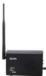
⑩ ELPA ワイヤレスコール中継器 EWC-T02 0120300 ¥21,800 サイズ:140×60×H90 重量:218g 通信方式:特定小電力(426MHz帯) 通信距離:見通し約100m 音量調節:4段階 (大:約70dB/中:約65dB/小:約60dB/切:無音) 使用温度範囲:0~40℃ 電源:AC100V(付属の電源アダプター使用) 消費電力:送信時/0.7W以下 待機時/0.5W以下 付属品:電源アダプター(コード長:約3m)
