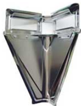
①オールステンレス Vカッター (L) S-0085 71 8055200 ¥18,000 外寸:210×100×H290 柄:ステンレス鋼 刃:ハイカーボステンレス鋼 ●安全ガイドカバー付 ●柄も錆に強いステンレススチール製 ●刃が長くシャープなので少ない力で開缶できます。 ※角缶18ℓの開缶専用です。
