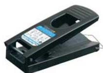
⑪マルチプレス KPM1 71 1151100 ¥5,600 外寸:384×175×H80(収納時) 重量:3kg 対応容器: 缶/1ℓ以下の飲料缶 ペットボトル/500ml〜2ℓまでの 飲料用(取手が無いもの) 材質:レバー/鋼板 表面処理(電着塗装) ベース/再生PET
