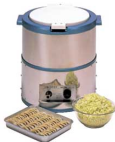
③プロシェフ 野菜脱水機 卓上型 VS-250N 0804700 ¥220,000 外寸:430×388×H457 電源:単相100V 50/60Hz 定格消費電力:175/135W 定格時間:連続 重量:26kg ●タイマースイッチ付(最長15分) ●4kgタイプ ●キャベツなら約2分で3kgを脱水することができま ※絞リ袋付
