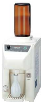
⑥瞬間加熱式 酒燗器 TSK-N11R ㉔ 7384500 ¥100,000 電源:単相100V 50/60Hz 消費電力:1.3kW 重量:4.5kg ●お酒が特殊ガラス管ヒーターの中を通る間に加熱されるため、旨味が損なわれません。 ●ぬる燗(45℃)〜あつ燗(65℃)まで、マイコン制御の温度管理により、いつでもお好みの温度で採酒できます。 ●お燗をせずに、常温酒を採酒したい時はヒータースイッチを切るだけで採酒できます。 ●「採酒終了」「酒桶給」をアラームで知らせる親切設計 ※紙パックでのご使用もできます。その際は専用スタンドを別途取付加工が必要となります。
