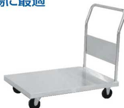
② ステンレス台車 SFD-D 導電ゴムキャスター 74 3006840 ¥218,000 外寸:900×600×H830 重量:25kg 材質:本体/SUS304 キャスター:伝導ゴム製 φ100
