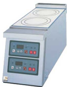
⑦IHマルチコンロ NIC23602 74 2145300 ¥322,000 外寸:230×600×H300 IHユニット:1.3Kw×2 電源:単相200V 総合消費電力:2.64kW 定常時最大電流:15A 重量:19kg コンセント形状: 対応鍋底サイズ:φ120~φ150 ●必要な電気だけを使用する省エネ設計 ●省スペース設計です。 ●清掃しやすい構造です。 ●多品種少量調理に最適です。 ●プログラム調理と手動調理の両方が可能です。
