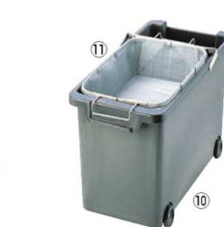
⑩強化耐熱プラスチック フライヤー用 油缶 (カゴ付) 71 5622500 ¥31,200 外寸:275×550×H335 容量:30ℓ 耐熱温度:265℃ 材質:本体・キャスター/ナイロン66GS 把手部/ステンレス製
