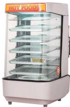
④スチームマスター MJ45A 8303410 ¥205,000 外寸:400×500×H756 電源:単相100V/979W 照明:30W(サークライン) 温度調節:マイコン制御 操作盤:タッチパネル式・デジタル温度表示 安全装置:漏電ブレーカー・フロートスイッチ・サーミスタ・リセットバイメタル 滴水水量:4.5ℓ 重量:24.5kg 収納個数:45個(1トレイ9個×5段) 材質:ガラス・ステンレススチール・ポリプロピレン
