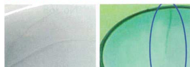
釉面にヒビが入った磁器の透明釉 素地ごと割れたカップ
