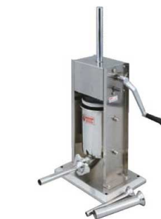
⑦LT 18-10 ソーセージ フィーラー ページコード 商品コード 価格 N5750 1-0413-0701 8401000 ¥123,900 外寸: 240×165×H405 シリンダー容量: 3ℓ シリンダー内径: φ125×H200 ※内径φ13, φ17, φ21のファンネルがセットされています。
