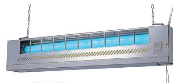
屋内用 ⑤バイオニー 捕虫器 ㍿ ページコード 商品コード 価格 G-201型 2-2058-0501 8490000 ¥32,300 685×95×H120 重量:2.7kg 電源:単相100V 有効面積:40~60㎡ 捕虫方法:捕虫紙粘着方式 誘虫ランプ:20W(FL-20SBL) 材質:ステンレス(SUS 304) 捕虫紙:1枚入り 捕虫テープGC-20S(20枚入) 2-2058-0502 8490010 ¥6,000 ㍿
