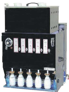
⑤ガス自動酒燗器「お燗番」GNT-5 ㊦ ページコード 商品コード 価格 LP 2-1086-0501 4296310 ¥700,000 L3A 2-1086-0502 4296320 ¥700,000 採酒口:5ウェイ 能力:120本/6分間 ※温度:30℃～93℃可変 ●バーナーの取付位置を左側に取付けすることが可能のため奥行の少ないスペースへの設置ができます。
