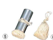
⑤パイプ 油引
