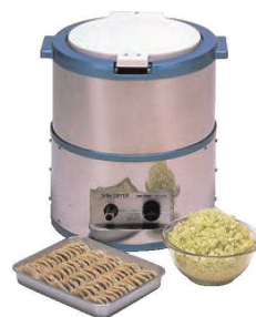
③プロシェフ 野菜脱水機 卓上型 VS-250N ページコード 商品コード 価格 3-0893-0301 0804700 ¥278,000 外寸:430×388×H457 電源:単相100V 50/60Hz 定格消費電力:175/135W 定格時間:連続 重量:26kg ●タイマースイッチ付(最長15分) ●4kgタイプ ●キャベツなら約2分で3kgを脱水することができます。 ※絞リ袋付
